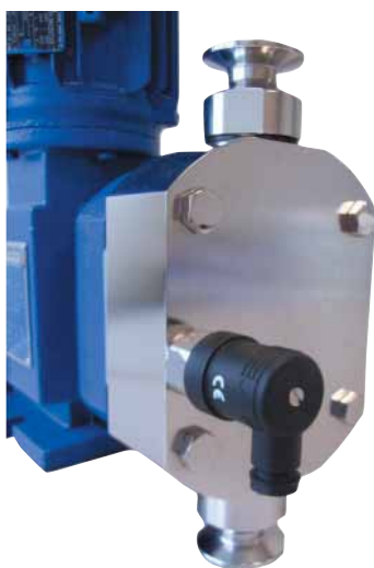
Elektropolierter Pumpenkopf Ra <0,8µm mit Druckschalter zur Membranüberwachung
