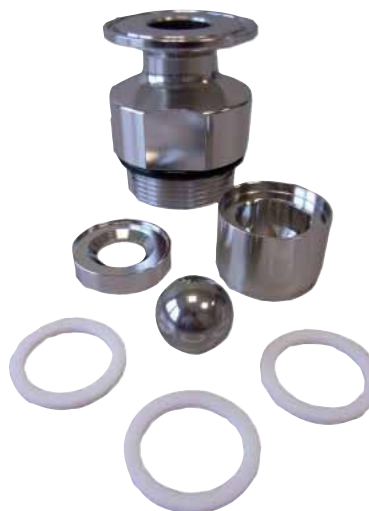
Clamp-Anschluss und Kugelventil in SS316L mit Ra <0,8µm, PTFE-Dichtungen (FDA)
