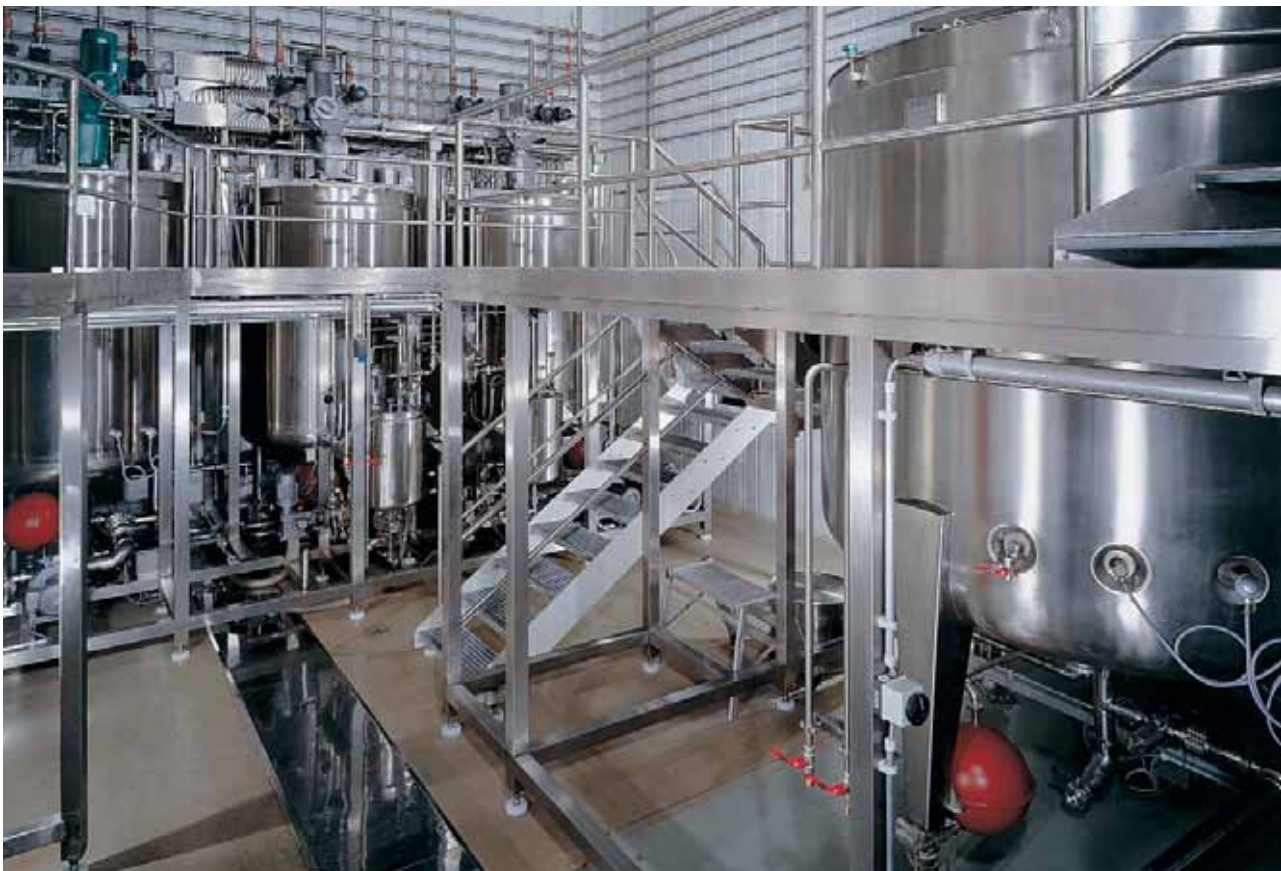
Lotionen und tensidhaltige Waschlösungen werden in parallel betriebenen Batch-behältern hergestellt.
