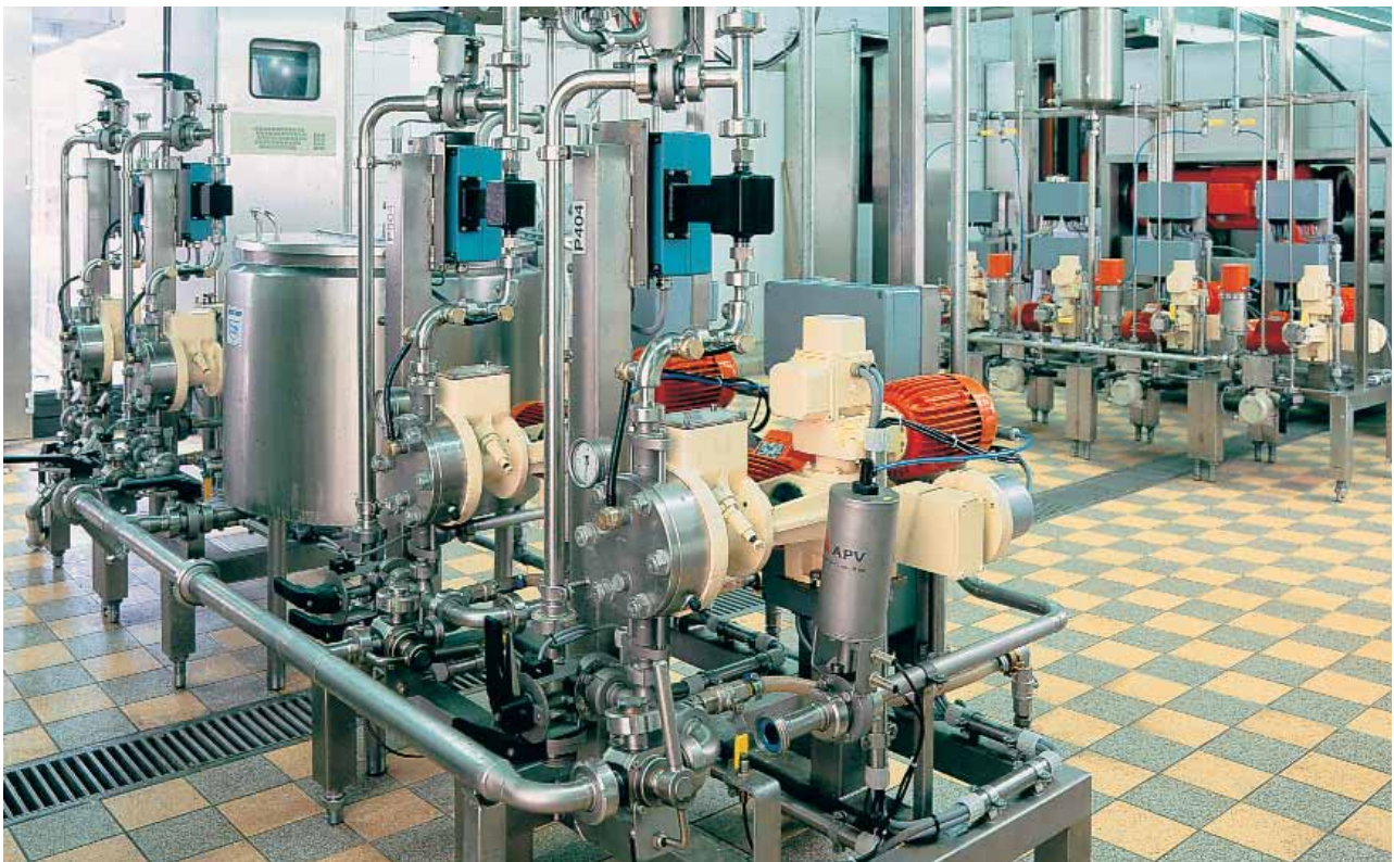
Kontinuierliche Herstellung von aufgeschäumten Süßwaren. Zum Einsatz kommt ein Dosierpumpen- und Durchflußmessersystem.
